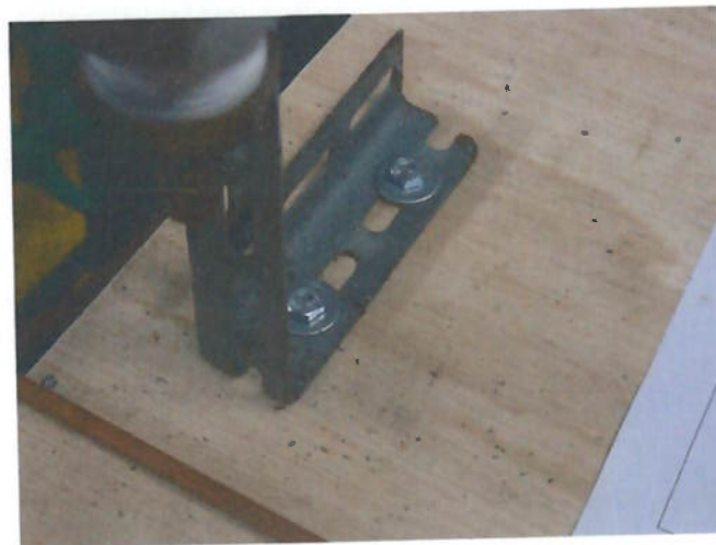
Figura 11: Detalhe da fixação do suporte na mesa
