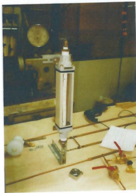
Figura 10: Suporte do rotâmetro montado na mesa
