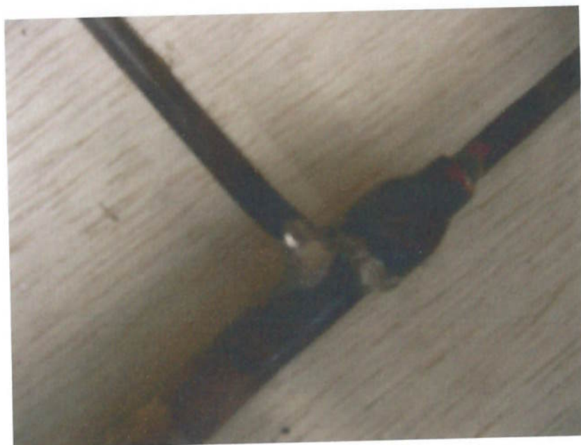
Figura 8: Detalhe dos tubos do trocador depois de soldada a tampa de vedação
