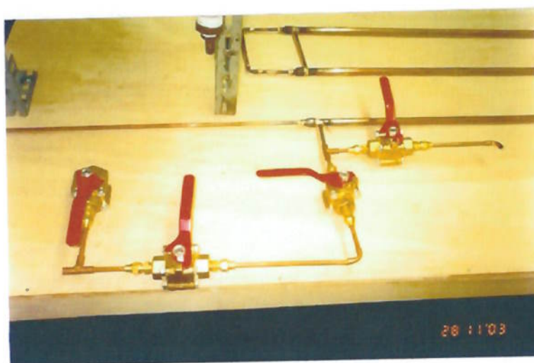
Fig. 6: Detalhe da montagem das curvas para a tubulação interna do trocador
